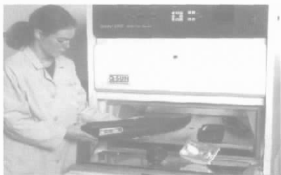
图 5 平板型氙灯试验箱可放置立体三维试样
